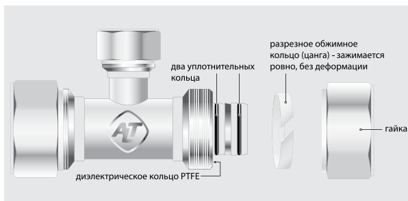
Рис.1. Конструктивные элементы цангового фитинга указаны.
